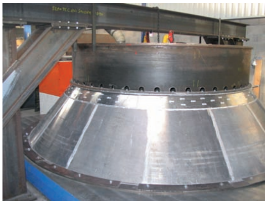
AFS – Testaufbau für den Übergangskonus der Ariane V.
